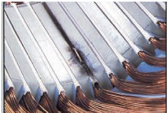
شکل ۱۰-۳- اتصال سیم‌های حامل جریان با بدنه فلزی یک موتور الکتریکی
